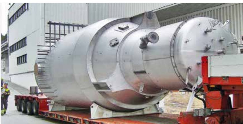
Mitte: Einbringung Fließbett-Coater GFC 2200
